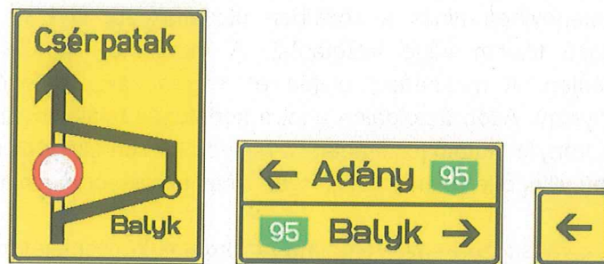
17. ábra: Terelőutak útirány-előjelző és útirányjelző táblái (e-UT 04.02.11 ÚME 111. ábra)
